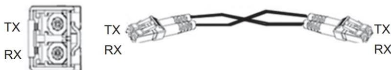
Рисунок 11. Кабельное соединение оптического модуля SFP
