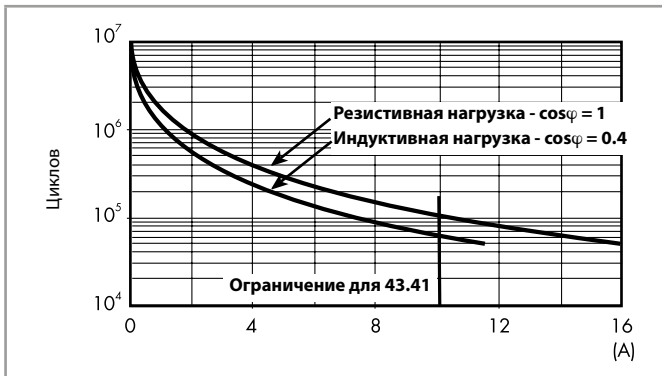
F 43 - Электрическая долговечность (АС) при ном. нагрузке
