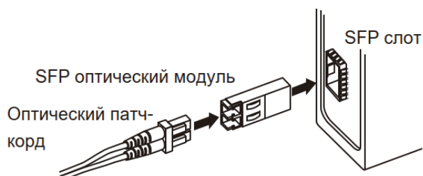
Рисунок 26. Подключение оптического модуля SFP
