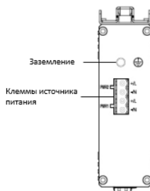
Рисунок 9. Верхняя панель 5-портового коммутатора 10/100/1000 Мбит/с
