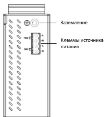
Рисунок 11. Верхняя панель 8-портового коммутатора 10/1000 Мбит/с
