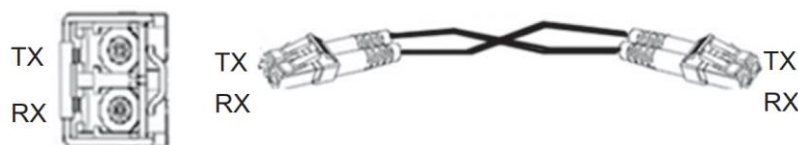
Рисунок 25. Кабельное соединение оптического модуля SFP
