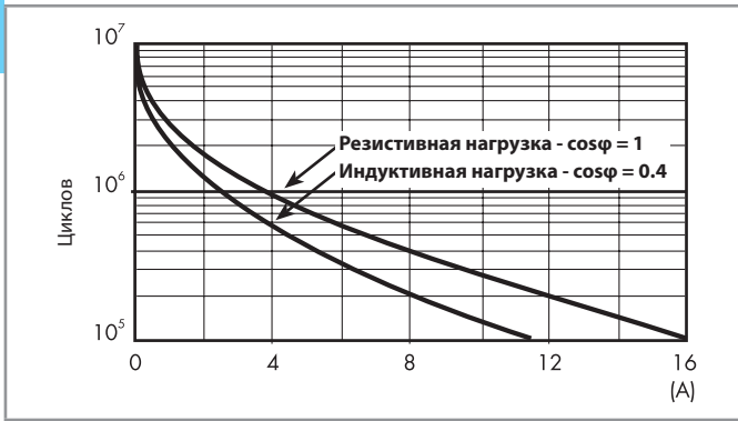
F 45 - Электрическая долговечность (AC) при ном. нагрузке тип 45.31...4310
