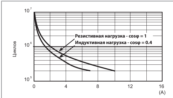
H 58 - Макс. отключающая способность DC1
