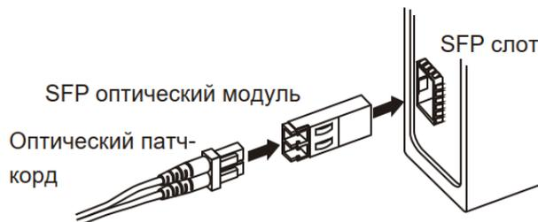
Рисунок 15. Подключение оптического модуля SFP
