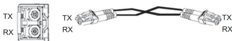
Рисунок 14. Кабельное соединение оптического модуля SFP
