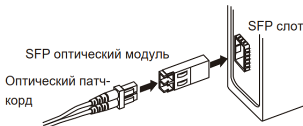
Рисунок 11. Подключение оптического модуля SFP
