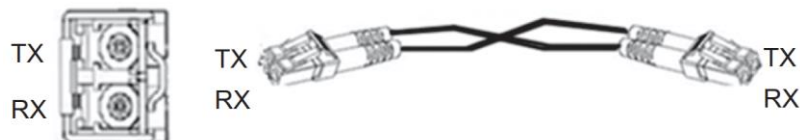
Рисунок 10. Кабельное соединение оптического гигабитного модуля SFP
