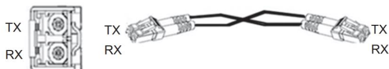
Рисунок 14. Кабельное соединение оптического гигабитного модуля SFP
