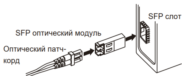
Рисунок 15. Подключение оптического модуля SFP
